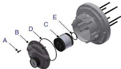
Fig 9.6 - Emplacement de l'élément séparateur
