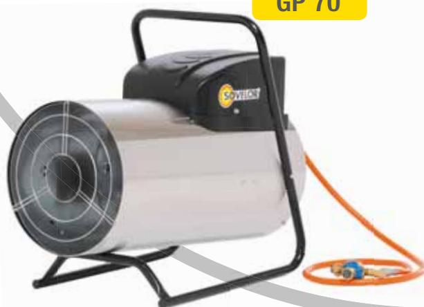
Les SOVELOR GP/MI sont des appareils dont la mise en service et l'arrêt sont commandés de façon manuelle. Simples d'utilisation et robustes, leur allumage s'effectue par l'intermédiaire d'un piezo électrique et d'une vanne thermique. Le contrôle de flamme est assuré par thermocouple.
