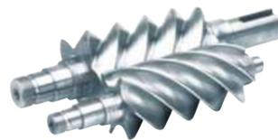
Le compresseur à vis comprime l'air dans un espace formé entre deux vis rotatives tournant en sens opposés. Avec le carter du compresseur d'air qui les entoure, ces vis forment l'entraînement à vis. Le fonctionnement d'un compresseur à vis repose essentiellement sur deux principes : l'injection de liquide ou le séchage. Ces deux versions existent en modèles mono-étagés et bi-étagés.
