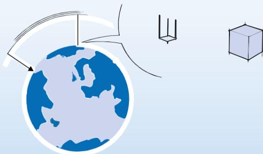
A la surface terrestre, l'air pèse approximativement 1,2 kg/m<sup>3</sup>. Cela signifie que la surface terrestre et tous les objets qui se trouvent dessus sont soumis à une pression appelée pression de l'air ou pression atmosphérique.
