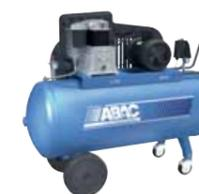
Un compresseur à piston se compose d'un ou plusieurs cylindres dotés de pistons entraînés par un moteur. L'air est aspiré dans le cylindre puis comprimé dans un ou plusieurs étages jusqu'à la pression opérationnelle. Après la compression, l'air comprimé passe dans le refroidisseur final et poursuit son chemin jusqu'au réservoir d'air.
