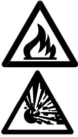
Pour éviter tout risque d'incendie ou d'explosion, le générateur PSA ne doit pas être installé à des endroits où il pourrait y avoir la présence de flammes libres d'étincelles ou de substances inflammables (gaz, vapeurs, brouillards et poussières).
