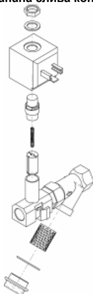
Рис.2 Очистка электроклапана слива конденсата
