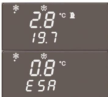
Dans des conditions normales de fonctionnement, le contrôleur affiche sur l'écran supérieur la température du POINT DE CONDENSATION et sur l'écran inférieur la température ambiante.
