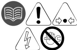
Avant toute opération d'entretien, isoler le purgeur de la pression et du courant électrique.
