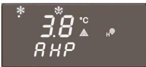
En partant d’une condition normale (pas d’alarme), dès que l’instrument enregistre une situation d’alarme, le code de l’alarme ainsi que l’icône respective clignotent alternativement avec la température, sont affichés sur l’**écran inférieur**.
