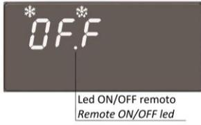
Si le séchoir est éteint par OFF à distance, l'écran du contrôleur affichera sur l'écran supérieur le message OFF et la del ON/OFF à distance clignotante.
